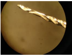
Fig. 27: sarro y enrollamiento en reversa distal, sistema K3®
