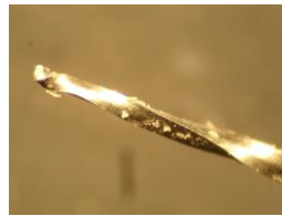
Fig. 30: desenrollamiento, sarro y fractura distal, sistema ProTaper®.
