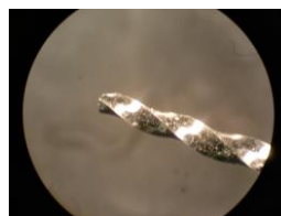
Fig. 32: sarro y fractura distal, sistema ProTaper®.
