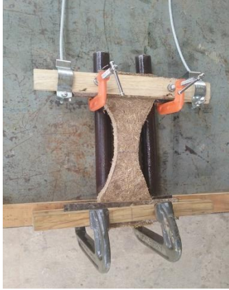
Agarre de la probeta
