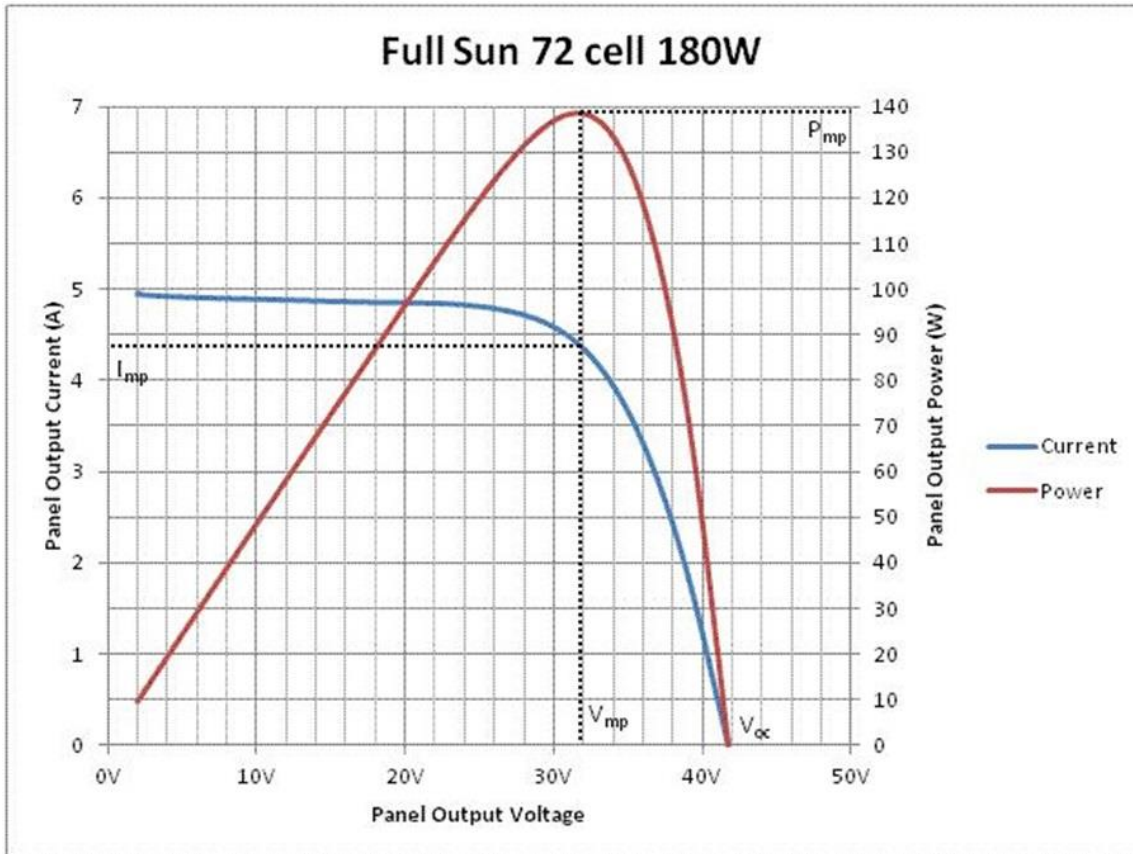
Figura 10. Voltaje frente a corriente para panel fotovoltaico de 180w y 72 celdas
