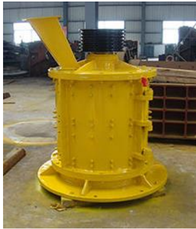
Figura 21. Trituradora de martillos de eje vertical
