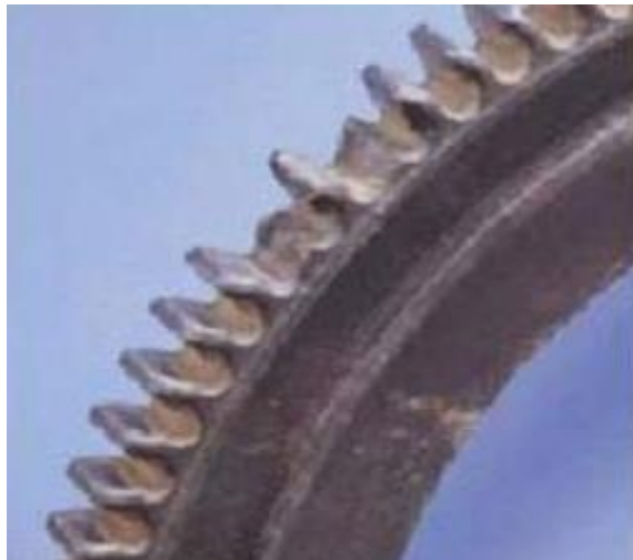
Figura 5. Desgaste por fatiga superficial
