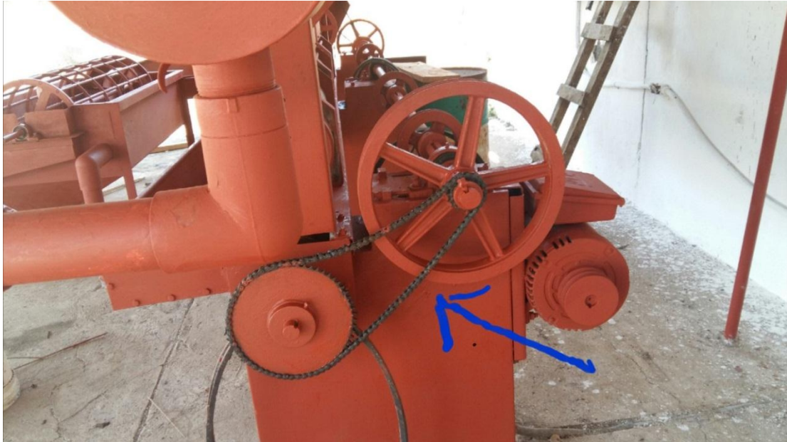
Figura 4. Faja que da movimiento a los pulperos
