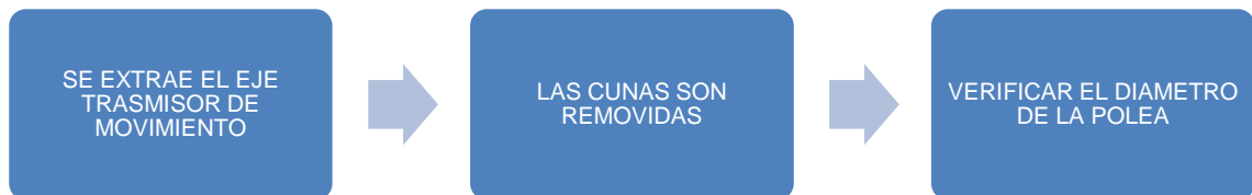
Figura 12. Inspección de poleas
