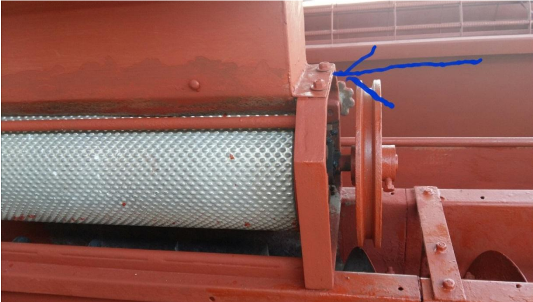
Figura 1. Pulpero extractor de la pulpa
