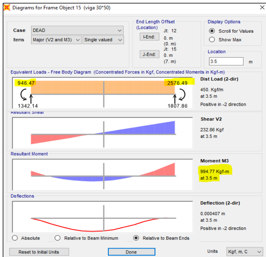
Figura 32. Momento de viga del segundo nivel entre ejes 1 y 2, marco X
