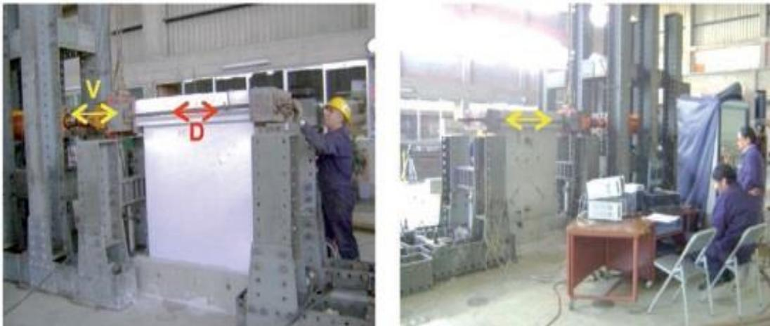
Fuente: RIOS, Rafael. *Comportamiento a fuerza cortante de muros delgados de concreto reforzados en su zona central con barras de acero, fibra de polipropileno y con fibra de acero.*
