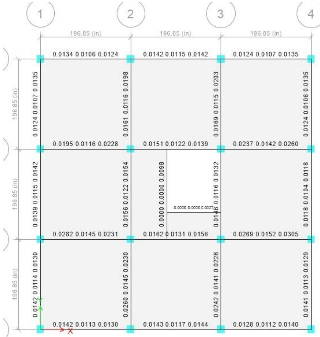
Figura 8. Refuerzo a corte vigas primer nivel estación de bombero
