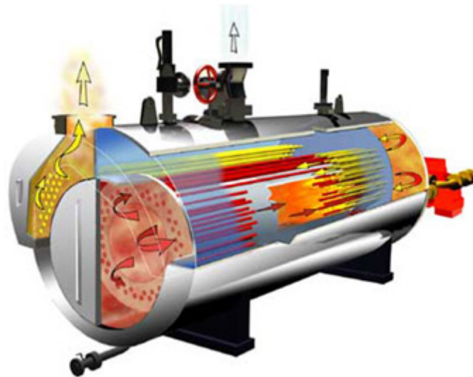
Figura 7. Componentes internos de la caldera pirotubular
