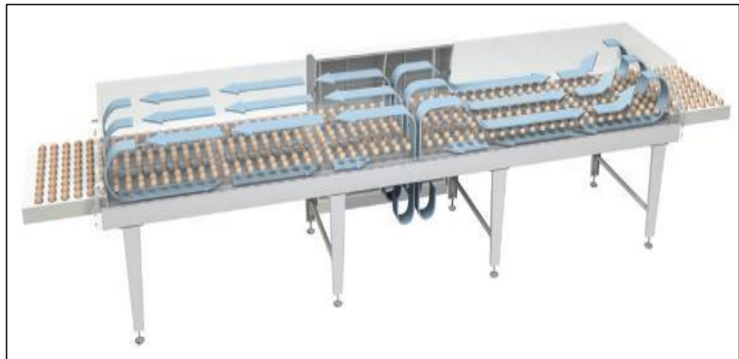
Figura 17. Funcionamiento túnel de enfriamiento
