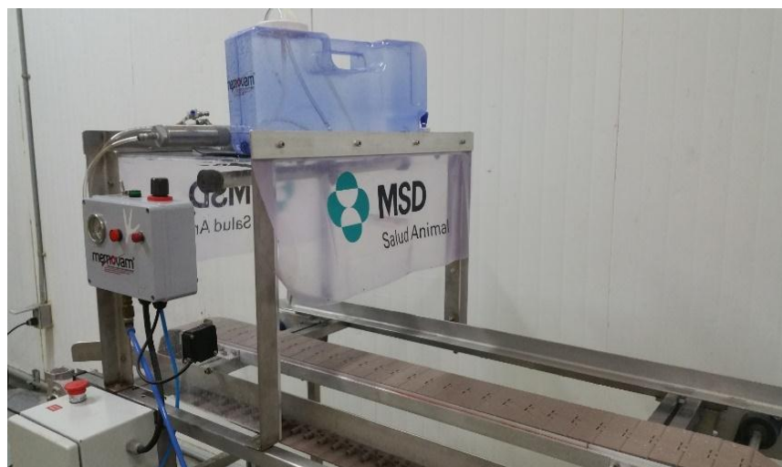
Figura 6. Maquina vacunación masiva por aspersión, vacuna tradicional cepa C2 contra enfermedad NC
