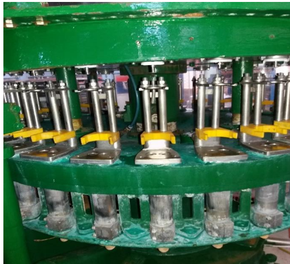
Figura 54. Pitones de la llenadora de la línea 2
