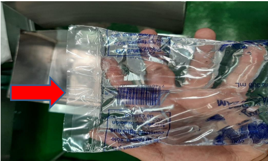
Figura 12. Mal sellado y corte de la bolsa de agua
