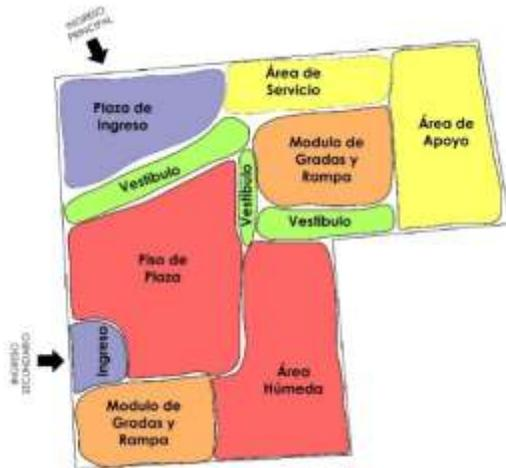
**Figura 54:** Diagrama de Burbujas Nivel 1
