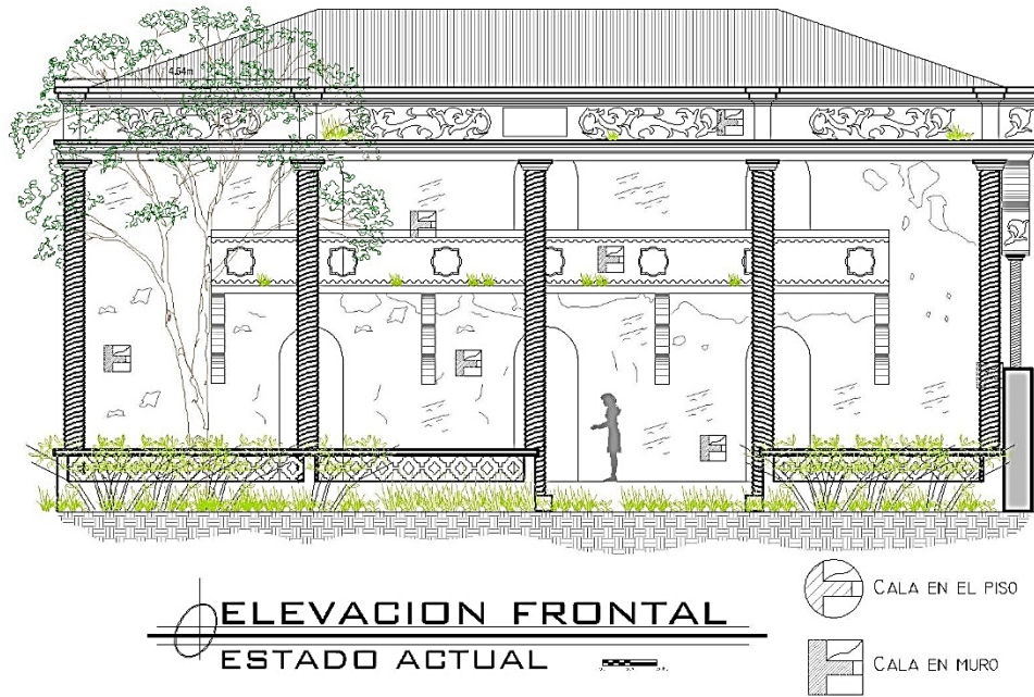
Figura 103. Ubicación de calas en muros de la fachada frontal del inmueble, con el fin de determinar material compositivo y etapas constructivas. Fuente: elaboración propia
