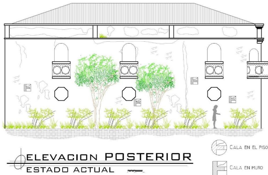
Figura 104. Ubicación de calas en muros de la fachada posterior del inmueble con el fin de determinar material compositivo y etapas constructivas. Fuente: elaboración propia
