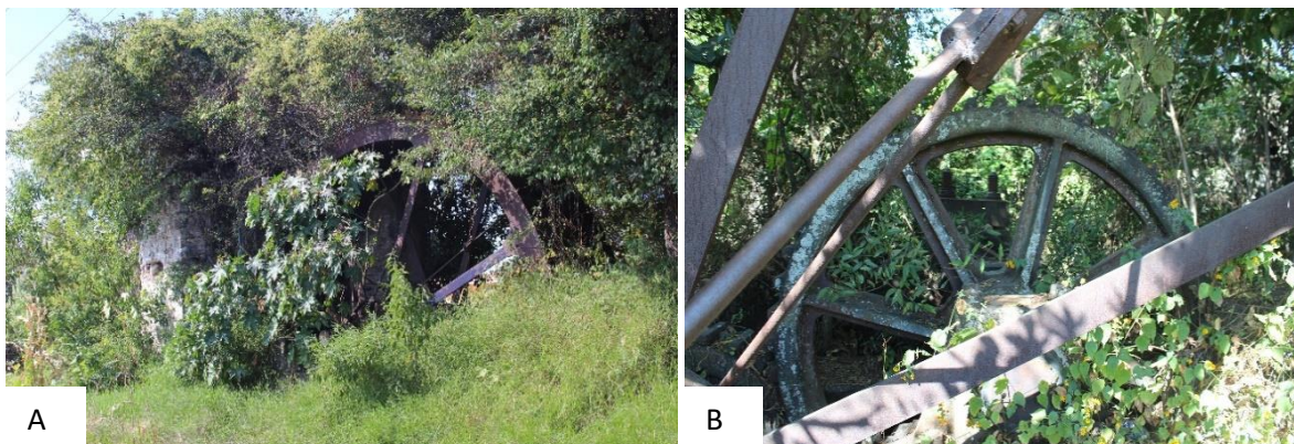
Figura 38-39. A: Vista de la rueda hidráulica de metal, marca Liverpool aproximadamente del siglo XIX, la rueda se haya anclada a unas columnas y muros y que giraban alrededor de un eje el cual esta empotrado a los restos de una construcción de mampostería a base de ladrillos y piedra que formaban el cuarto de rueda. La rueda tuvo como función transformar la fuerza del agua en energía mecánica a través de unos canjilones o aspas que recibían el golpe del agua proveniente de canal, que actualmente ya no existe. B: Engranaje de metal el cual iba acoplado al piñón de la rueda, posee dientes que anclan con el dispositivo anterior mencionado. Fuente: Velásquez Luna, 2019.
