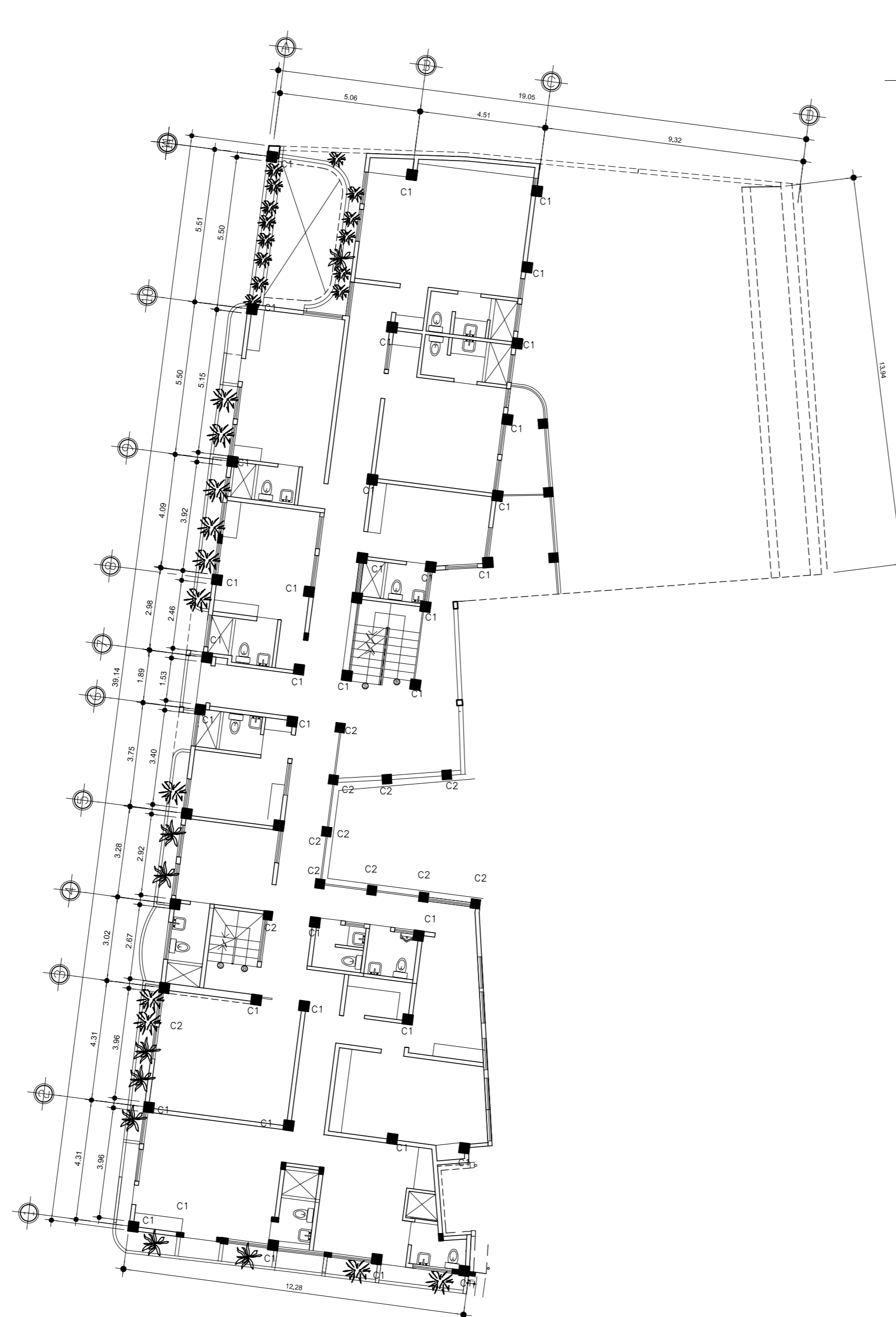
PLANTA DE COLUMNAS SEGUNDO NIVEL
