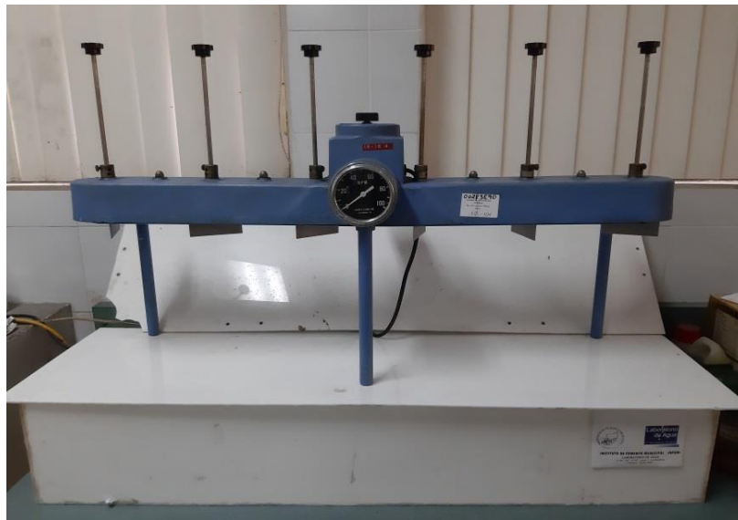
Figura 2. Equipo de prueba de jarras “Phipps & Bird, INC. Richmond, VA. 23228” de 6 jarras utilizado
