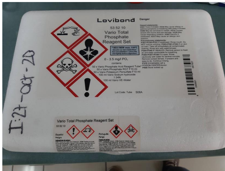
Figura 6. Set de reactivos “Lovibond” para fósforo total utilizado
