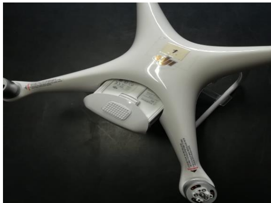
Figura 50. Inserción de batería dron DJI Phantom 4 pro
