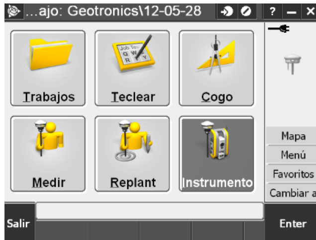
Figura 15. Pantalla principal del módulo Topografía General Trimble M3
