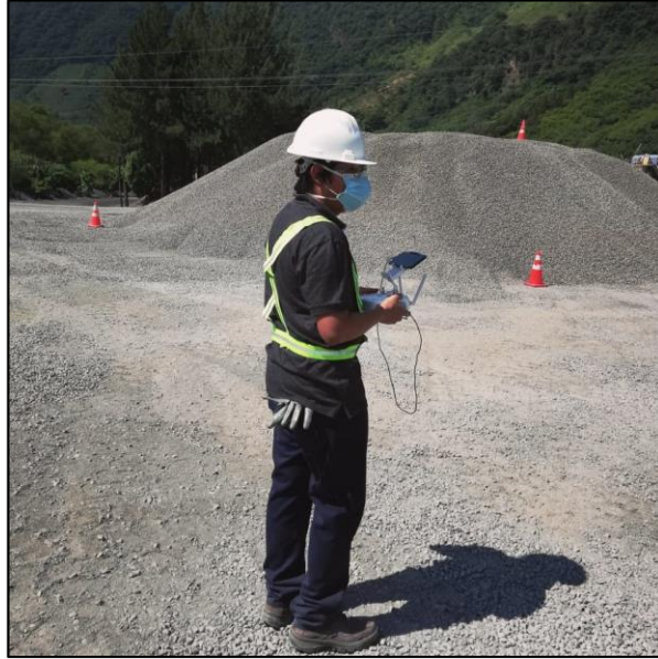
Figura 55. Configuración de mapeo de montículo de agregados
