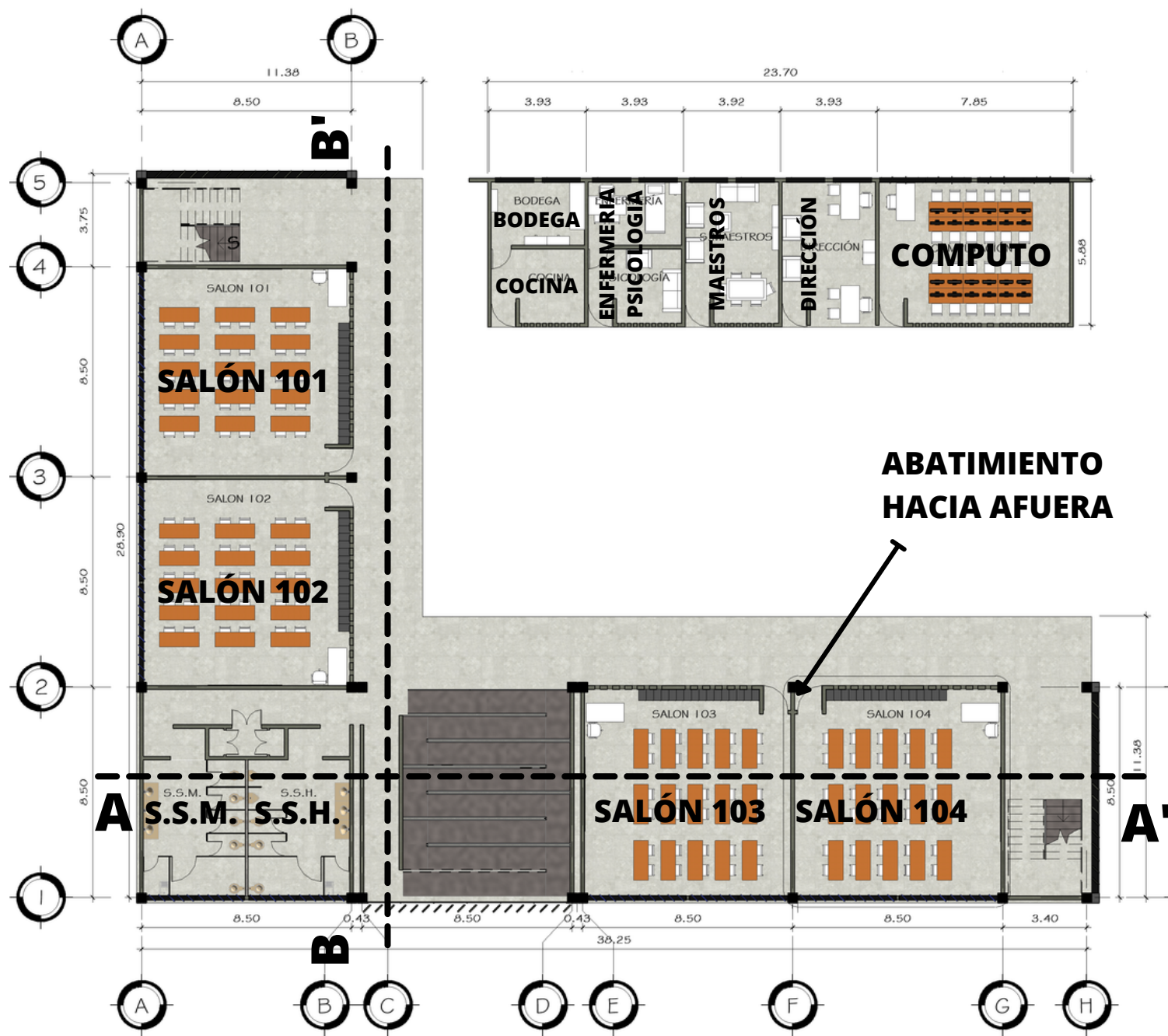
PLANTA ARQUITECTÓNICA PRIMER NIVEL ESC: 1/200
