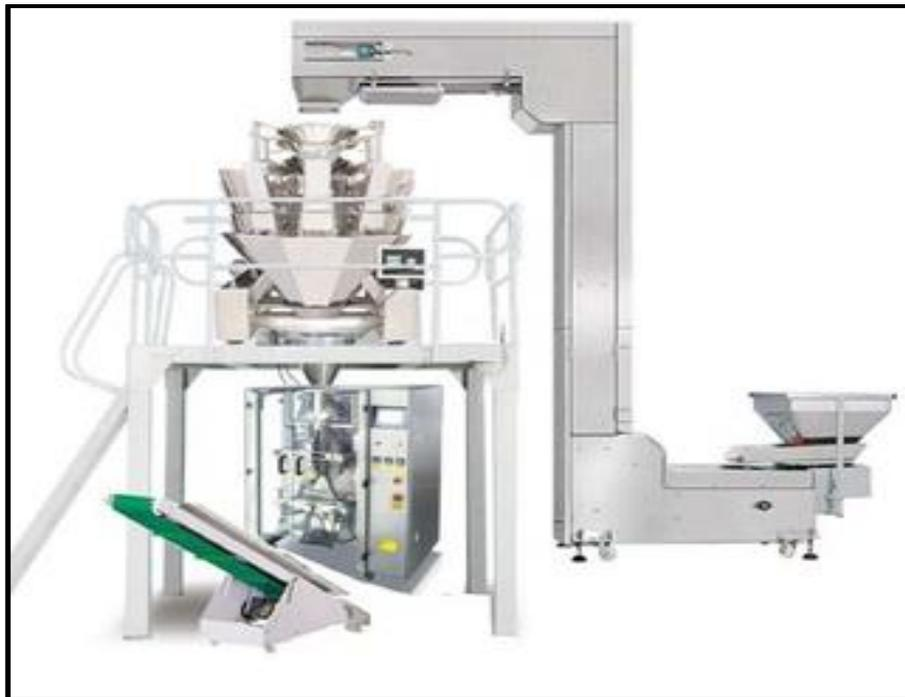
Fuente: Alibaba. *Envasadora con multicabezas*. [https://www.alibaba.com/product-detail/ENVASADORA-CON-MULTICABEZALES\\_156119587.html](https://www.alibaba.com/product-detail/ENVASADORA-CON-MULTICABEZALES_156119587.html). Consulta: 5 de agosto de 2018.
