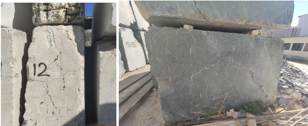
Figura 6. Materia prima en mal estado (bloques fracturados)
