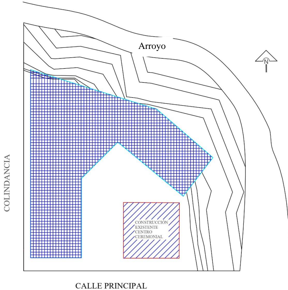
PLANO DE GRILLA ARQUITECTÓNICA BASADA EN COMPOSICIÓN. RETÍCULA DE 1m x 1m
