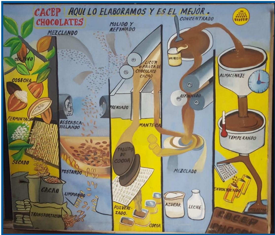
Ilustración 28: Paz. Proceso Productivo del Cacao en Agroindustria Rural. Hacienda Jesús María. Noviembre 2018.
