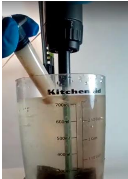
Figura 51. Aplicación de coagulante en mezcla rápida
