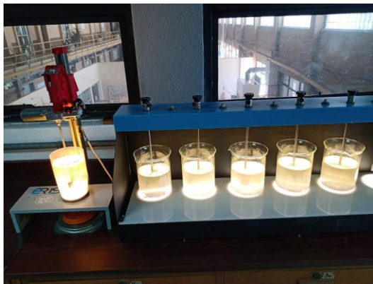
Figura 54. Prueba jarras con agitador de laboratorio y agitador experimental utilizado en el bloque 1
