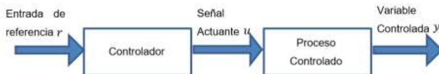
Figura 4. Esquema de un sistema de control de lazo abierto
