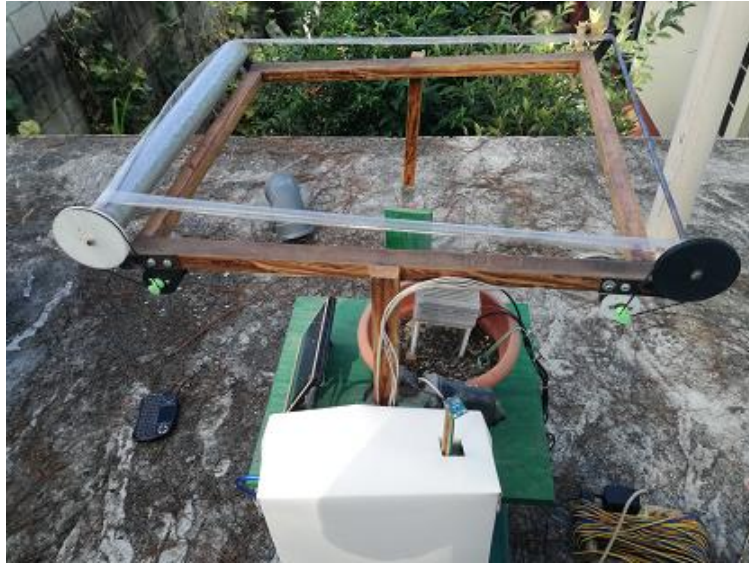
Figura 44. Actuador de sombra en funcionamiento
