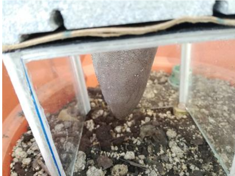
Figura 46. Actuador de condensación empañado
