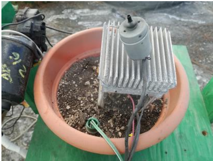
Figura 45. Actuador de condensación en funcionamiento
