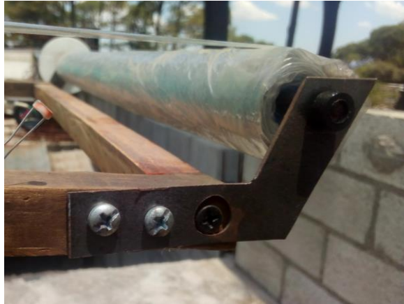
Figura 32. Rollo de nylon del actuador de sombra
