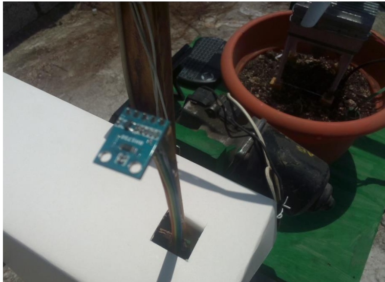
Figura 27. Ubicación del sensor BH1750
