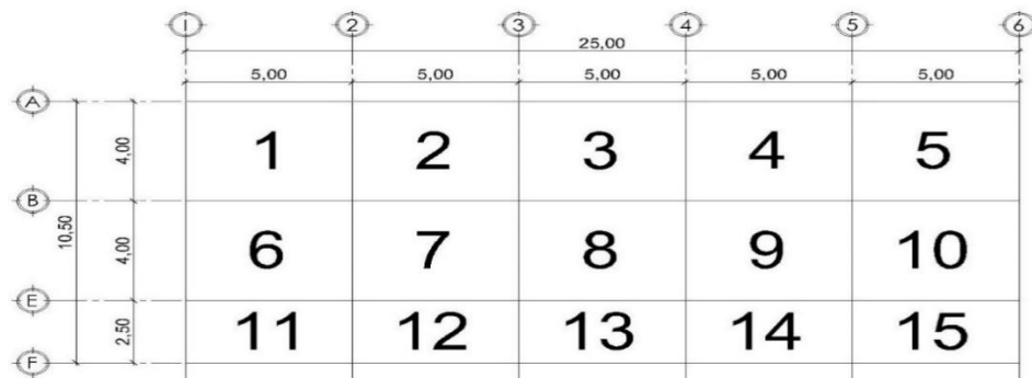
Figura 28. Distribución de losas en planta, Escuela
