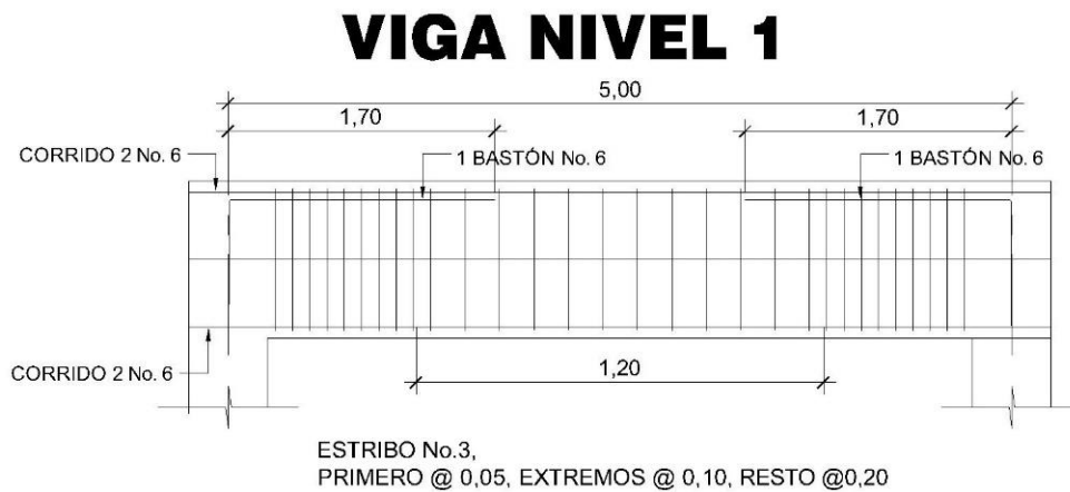
Figura 82. Detalle de armado de viga, primer nivel, CUM
