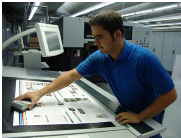
Figura 26. Mediciones con densitómetro
