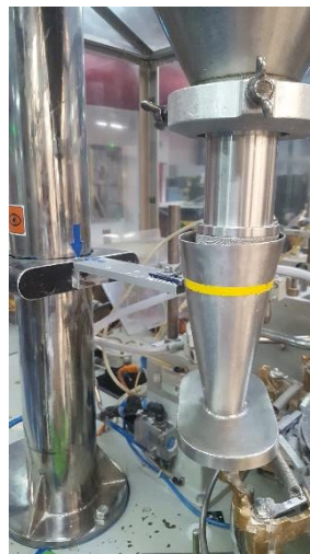
Figura 61. Centerlining de soporte de boquilla de dosificación
