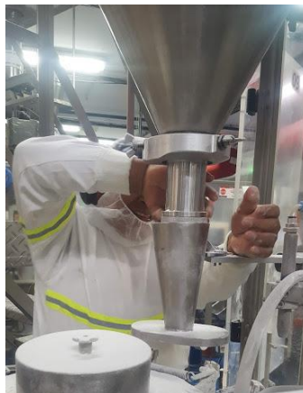
Figura 84. Boquilla con mejora implementada
