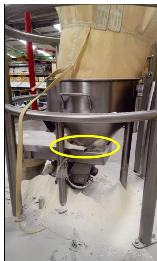
Figura 46. Barredura en silo
