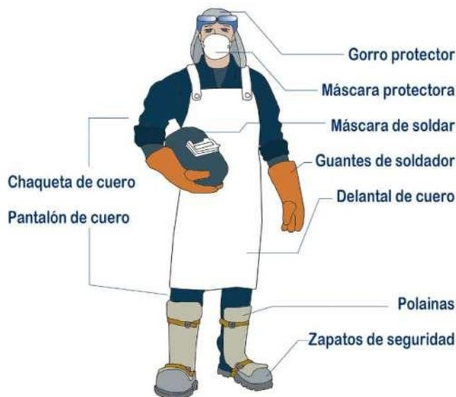
Fuente: Tecnología Minera. *Equipo de protección en trabajos de soldadura.*
