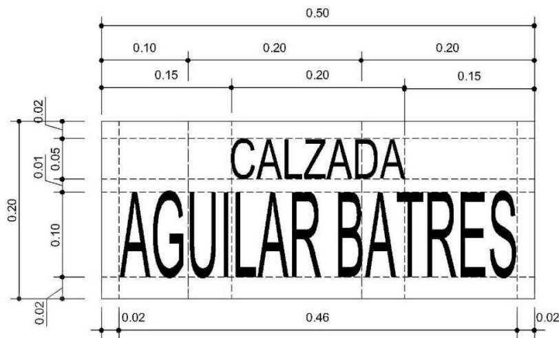
Figura 23. Dimensiones de texto para calzada Raúl Aguilar Batres
