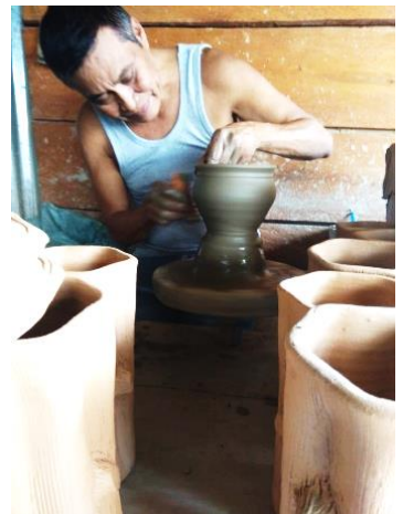
Figura 16 Proceso de elaboración de un jarro en el torno de alfarero, Fotografía: propia (Rabinal B.V. Guatemala 2018)
