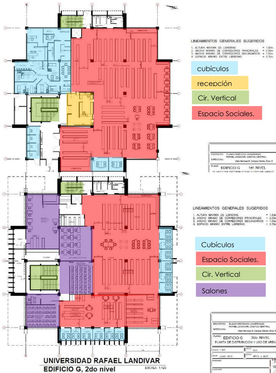
En la primera planta se puede acceder desde el costado oeste, siendo este el ingreso principal, el cual se conecta al módulo de gradas y al área de recepción en un sector distinto y con ingresos independientes exteriores se observa el área de cubículos empleados para realizar juntas o sesiones de estudio.
