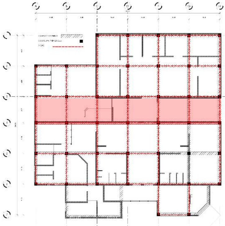
La losa que se empleara como entrepiso y cubierta final se empleara el sistema de losa con armado tradicional en ambos sentidos, que permite cubrir la luz libre y es un sistema conocido y empleado en el contexto donde se emplazara el proyecto.
