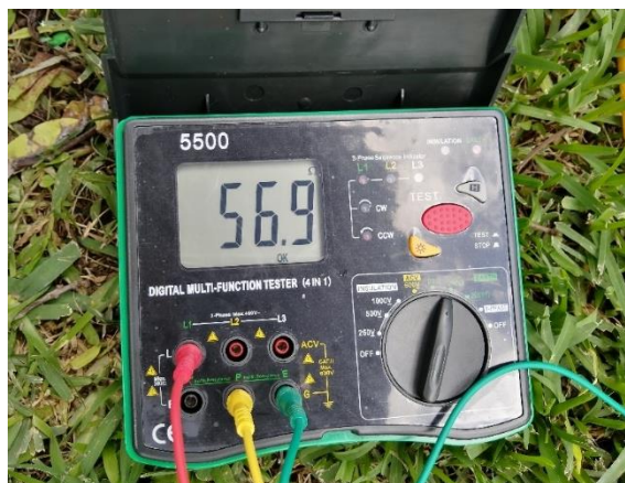
Figura 45. Resultado de la medición de resistividad del suelo
