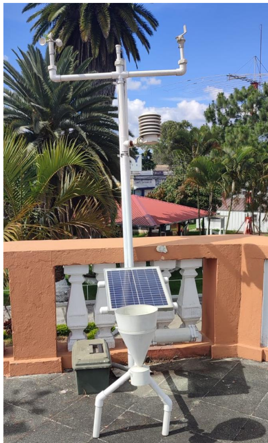
Figura 127. Estructura inicial estación meteorológica impresa en 3D
