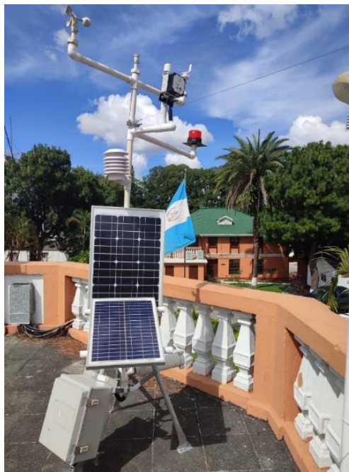
Figura 133. Resultado final de estación meteorológica impresa en 3D y acople de sensor de calidad de aire
