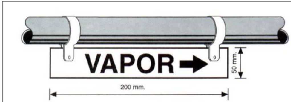
Figura 22. Colocación de rótulos en tubería
