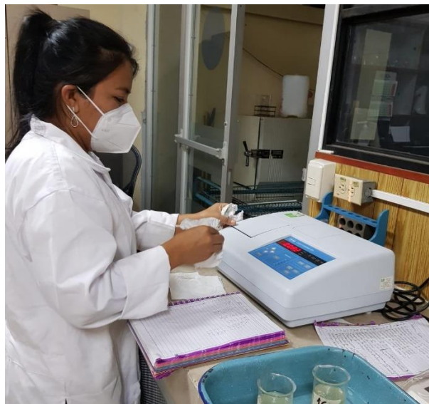
Figura 26. Medición de turbiedad
