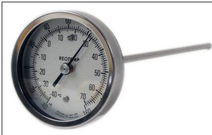
Figura 9. Termómetro para compostaje
