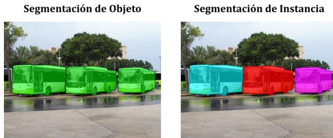
Figura 18. Ejemplo de segmentación de imagen
