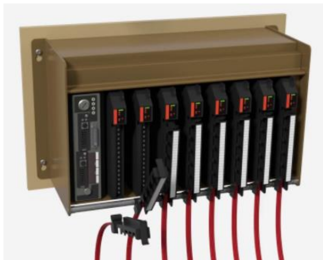
Figura 50. Desconexión de pinetas cableadas de módulos PLC-5
