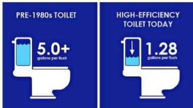
Reducción del consumo de agua potable en interiores mediante la instalación de artefactos sanitarios y grifería con bajo flujos por descarga o activación, incluyendo:
