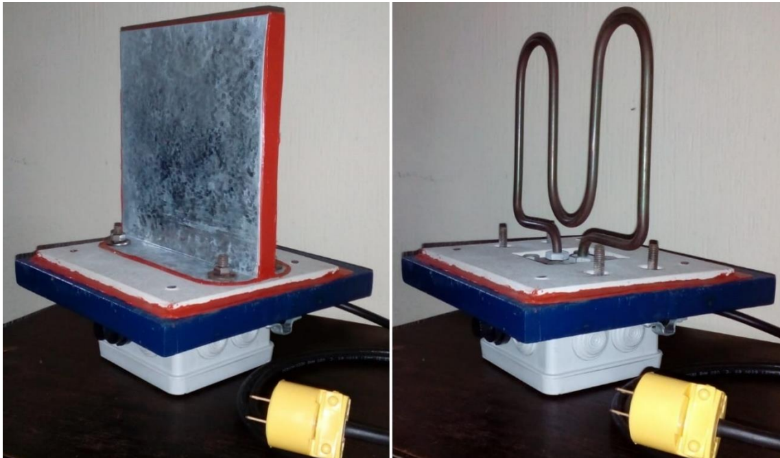
Figura 3. Resistencia eléctrica de calentamiento de superficie plana adaptable al equipo didáctico de estudio de transferencia de calor por convección forzada externa existente
