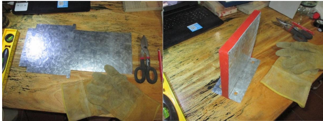
Figura 22. Construcción de placa plana de dos caras de calentamiento
