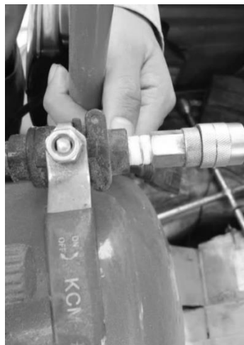
Figura 22. Llave de paso tipo esférica de compresor
