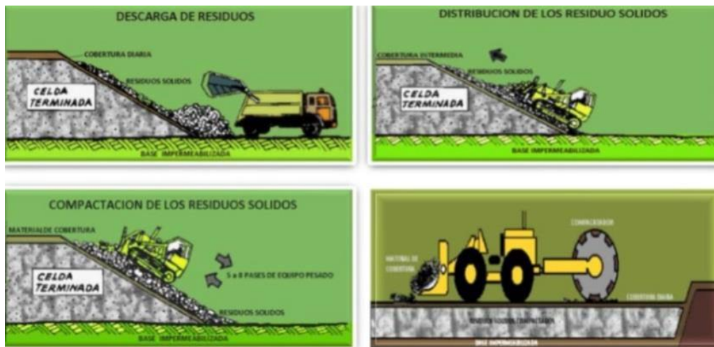
Figura 10. Relleno sanitario semimecanizado
