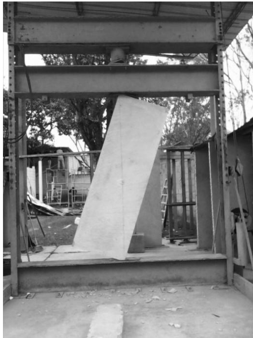
Figura 33. Prueba a corte de panel ecológico
