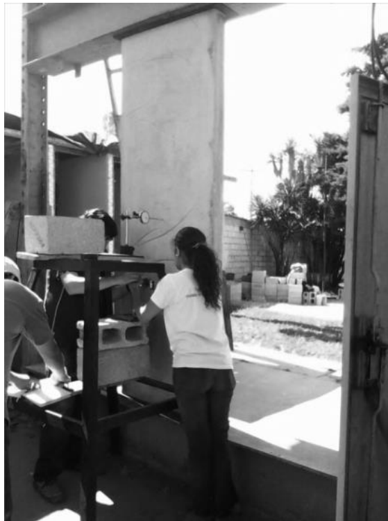
Figura 18. Prueba a compresión de panel ecológico
