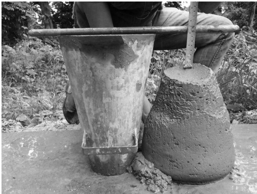
Figura 27. Resultado de la prueba de Revenimiento de 3,5”
