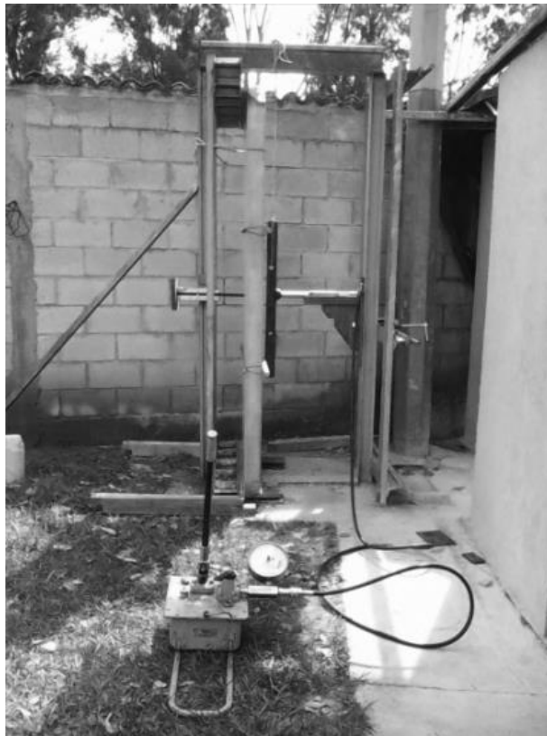
Figura 29. Prueba a flexión vertical de panel ecológico
