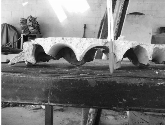
Figura 22. Efecto dovela del mortero envolviendo botellas PET
