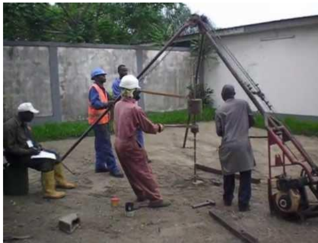
Figura 63. Ensayo sondeo dinámico
