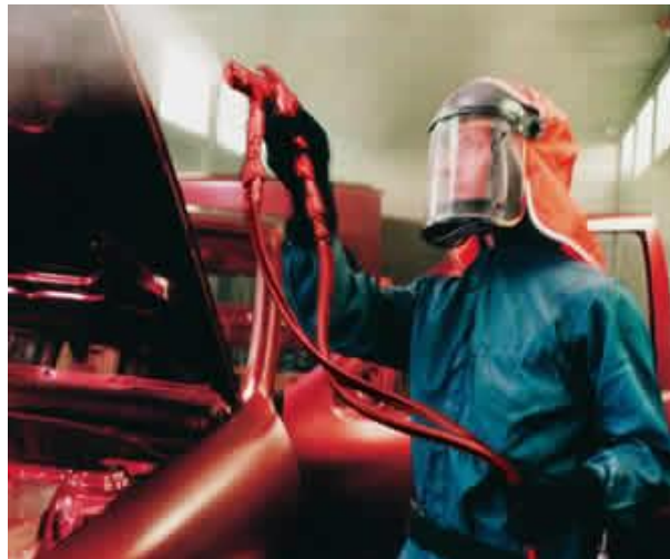
Figura 52. Uso correcto del equipo de pintura
