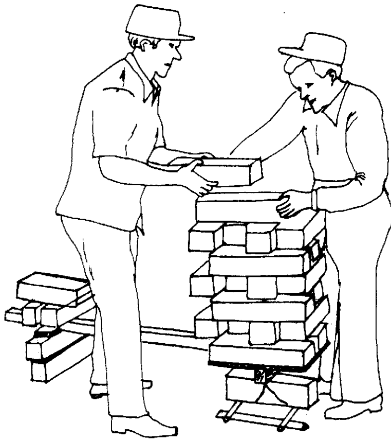
ENSAYO PARA DETERMINAR EL MÓDULO DE RUPTURA: APLICACION DE CARGA
