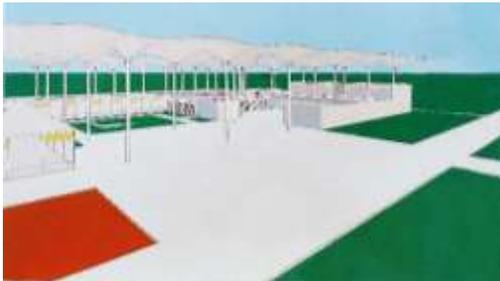
Fig. 40 Isométrico donde se observa el espacio interior que se puede obtener al aplicar estructuras de bóvedas de cascaron diseñadas por Amancio. Al mismo tiempo se observa la ventilación que se puede generar de forma ambiental sin necesidad de dispositivos activos.
