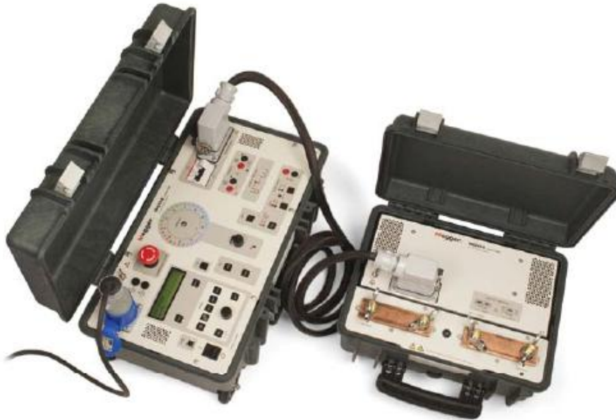
Figura 20. Sistema de prueba de inyección de corriente en primario Ingvar de Megger
