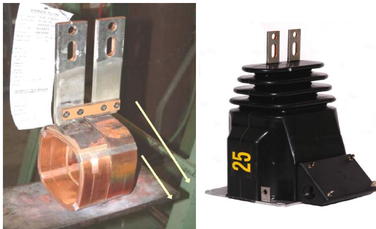
Figura 6. Transformador de corriente para media tensión modelo KOR-11 de ABB, antes y después del encapsulado en poliuretano
