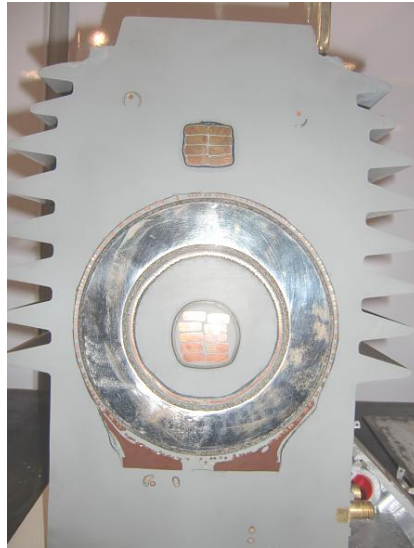
Figura 5. Transformador de corriente seccionado
