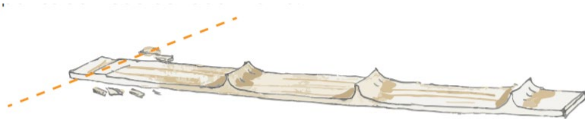
Imagen 52: Remoción de tabiques intermedios de las latas.
