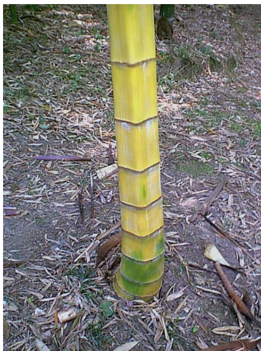
Fotografía 16: Modificación física del bambú por formaleta “Culmo cuadrado”.
