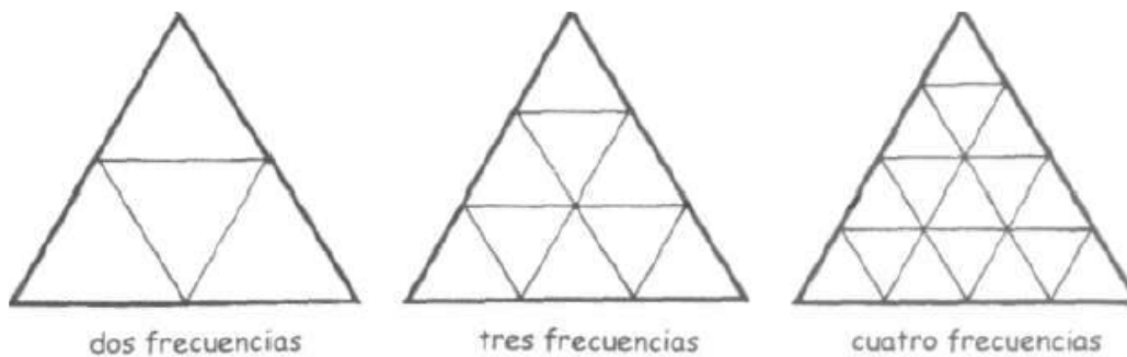
Imagen 25: Subdivisión de un lado geodésico triangular.
