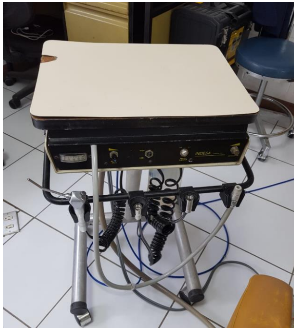
Carrito de controles, la parte superior de melamina se encuentra despegada, y la jeringa triple tiene problema de fuga
